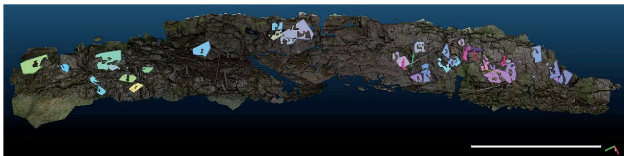
Рис. 9. Результат выделения плоскостей трещин на поверхности обнажения в программе CloudCompare с плагином Compas
