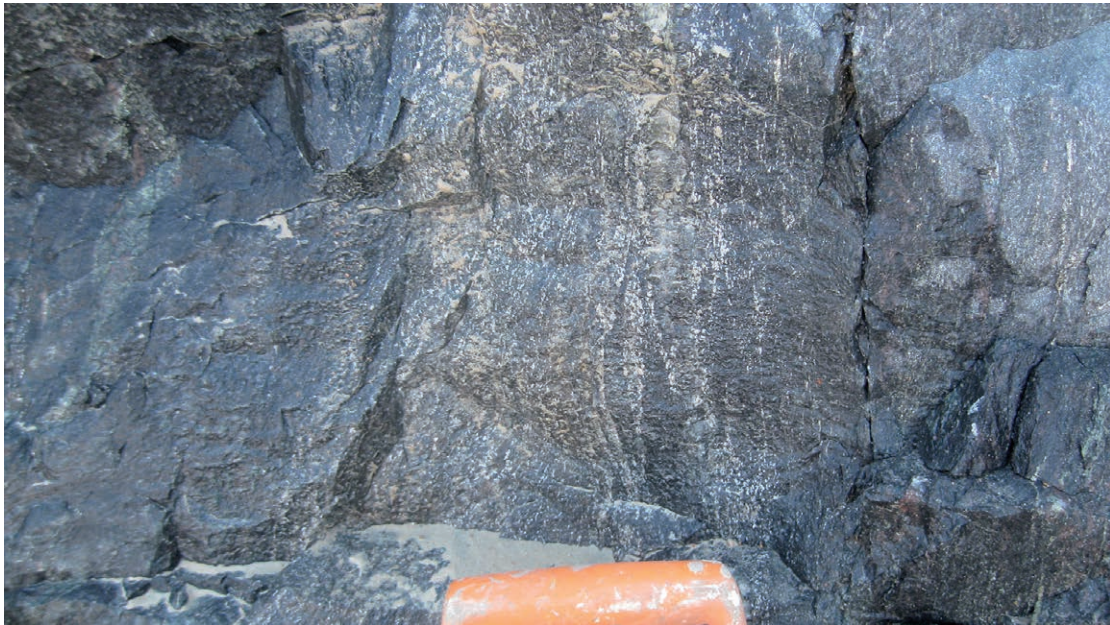
Рис. 2. Южный борт карьера Новые Пески. Главная рудная зона. Субвертикальная зона (субмеридионального простирания) арсенипиритового оруденения (с содержанием Au в руде до 40 г/т и более) мощностью до первых десятков см. Июнь 2020 г. Фото П. В. Фролова
