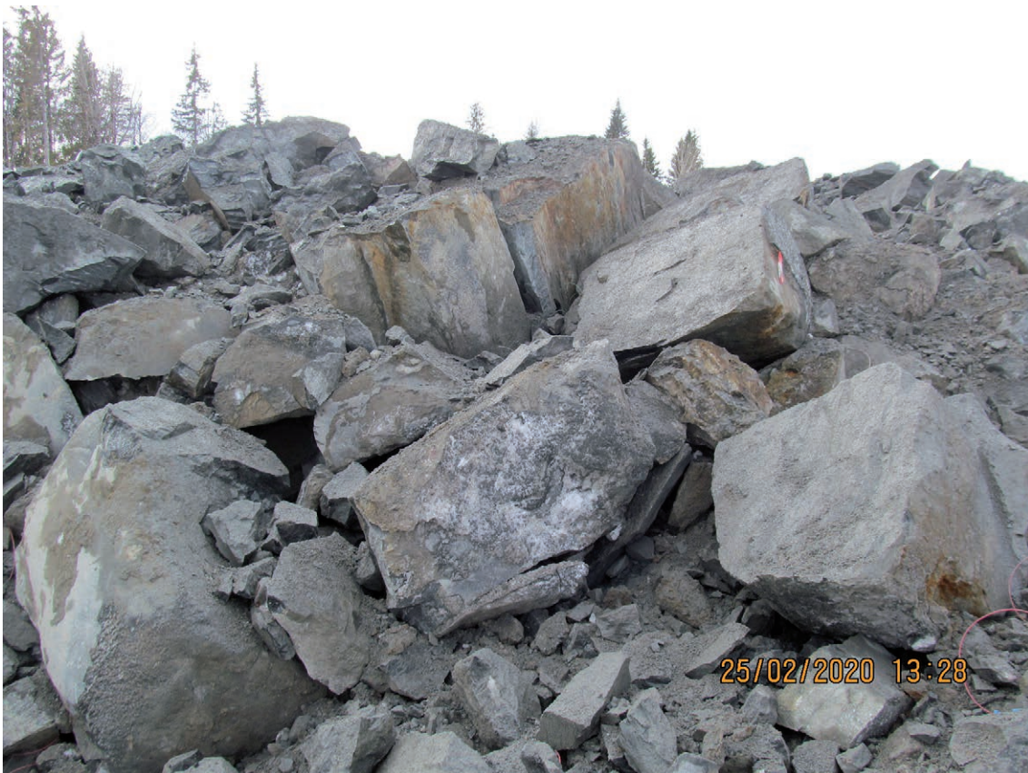
Рис. 7. Карьер Новые Пески после взрыва. 25.02.2020. Глыбы, негабарит. Фото В. М. Тытыка Fig. 7. The Novye Peski quarry after the explosion. 25.02.2020. Blocks, oversized. Photo by V. M. Tytyk
