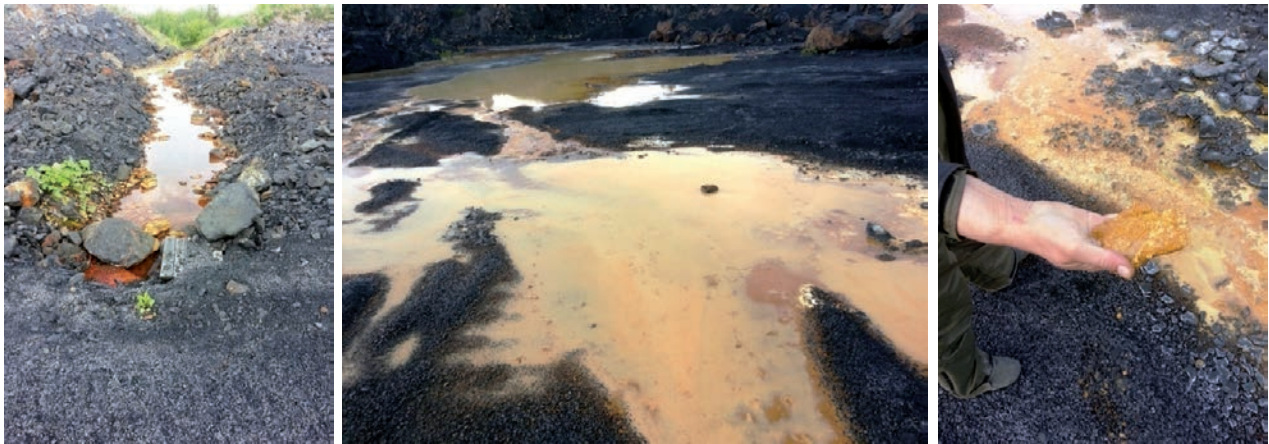
Рис. 2. Места отбора проб воды в Максовском карьере (26.06.2015, фото Н. В. Кулик): слева – проточный режим; в центре – застойный режим; справа – продукты окисления сульфидов Fig. 2. Water sampling sites in the Maksovo quarry (26.06.2015, photo by N. V. Kulik): on the left – flow regime; in the center – stagnant regime; on the right – products of sulfides oxidation
