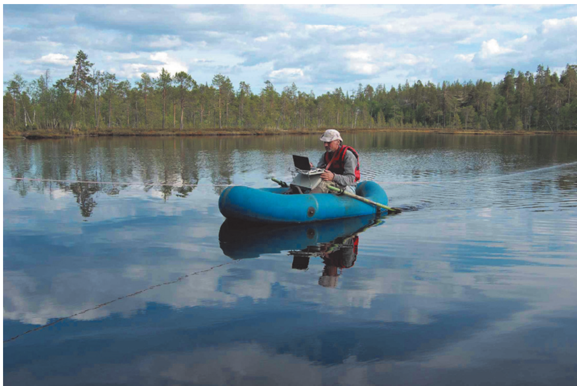
Рис. 2. Пример работы методом георадиолокации на пресноводных акваториях (оз. Верхнее, ББС МГУ)
