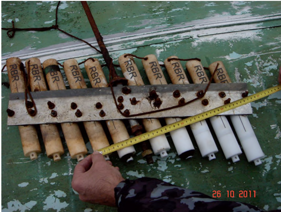
Рис. 3. Измерительная конструкция после извлечения из озера в октябре 2011 г. Граница вода – донные отложения хорошо определяется по наличию темного налета на поверхности датчиков
