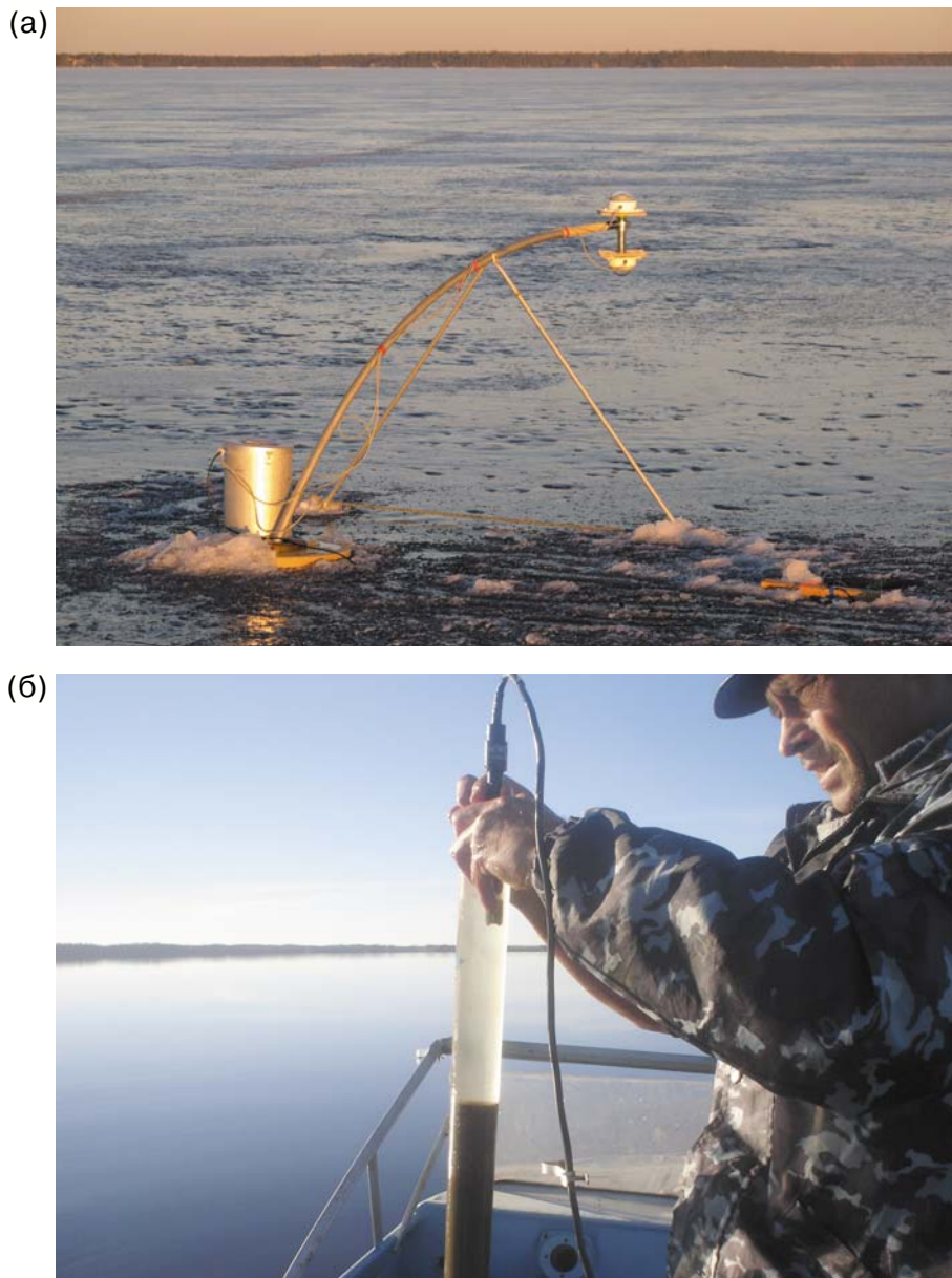
Рис. 4. (а) Измерение потоков радиации на поверхности Онежского озера; (б) измерение содержания растворенного кислорода в надилловой воде Н. И. Пальшиным, оз. Вендюрское
