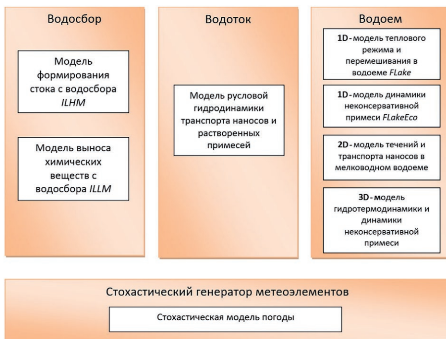
Рис. 1. Структура системы моделей для оценки процессов тепло- и массопереноса в системе «водосбор – водоток – водоем»
