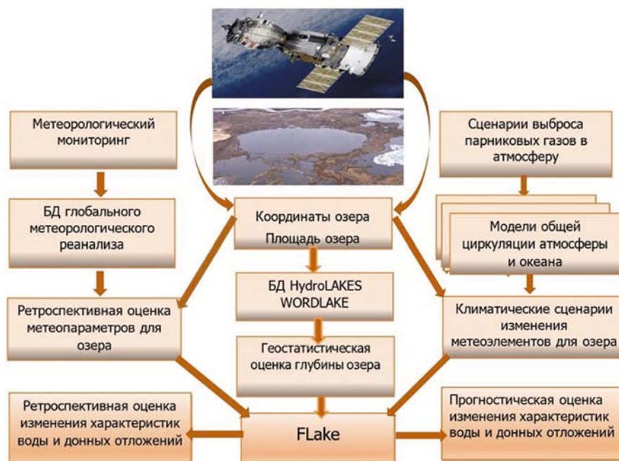
Рис. 2. Схема ретроспективной и прогностической оценок абиотических характеристик неизученных озер с использованием методов дистанционного зондирования и математического моделирования
