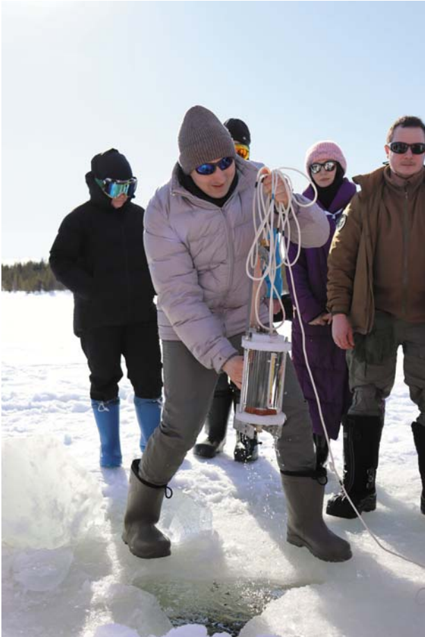
Отбор пробы воды при помощи батометра
