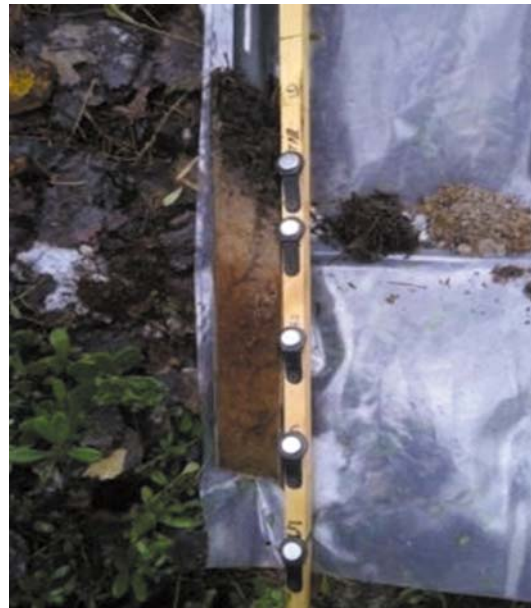
Рис. 2. Закладка серии термохрон-аудитора в почвенный профиль с учетом мощности генетических горизонтов
