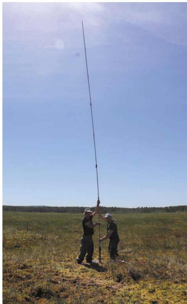
Рис. 6. Бурение торфяной залежи на болоте Самбальское (Пряжинский район)
