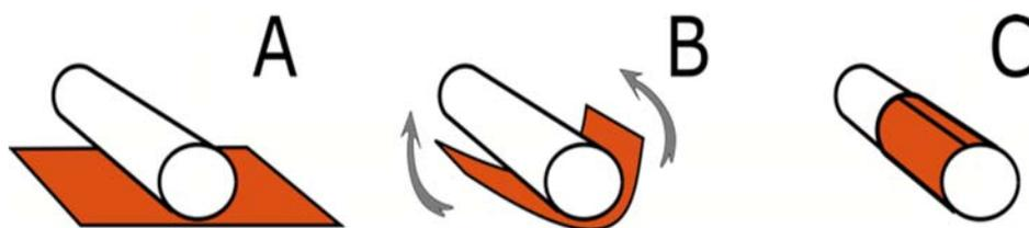
Рис. 1. Этапы изготовления кольца на нагретой трубке: А – исходное положение, В – закручивание заготовки, С – готовая заготовка со сведенными концами
